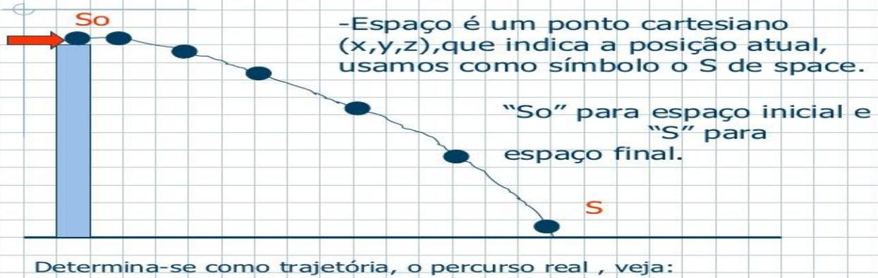
Quando ocorre uma variação nas posições ou espaços ( $\Delta S = \text{deslocamento}$ ), devemos primeiramente verificar o sistema métrico que está sendo utilizado e em segundo lugar o seu módulo, efetuando o seguinte procedimento matemático.
